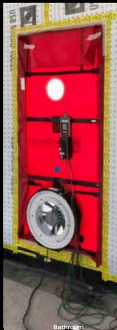
Rappresenta un efficiente controllo sulla corretta posa serramenti e delle coperture in legno ai fini comfort termico ed acustico. E' fondamentale per la verifica dei punti di condensa interstiziale unitamente alle verifiche termografiche ed a ricerche con fumo al glicole ed anemometro. E' inoltre un test obbligatorio richiesto da diversi protocolli energetici europei.
